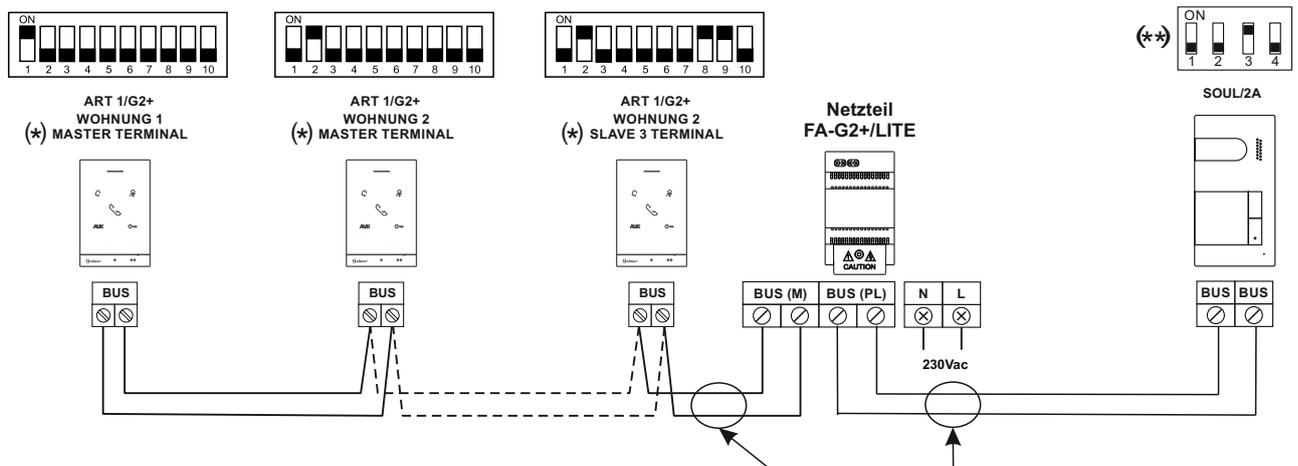
(\*) DIP-Schalter der Audiosprechstellen: (\*\*) DIP-Schalter der SOUL-Türstellen: Verwenden Sie bevorzugt geschirmte BUS-Kabel.
