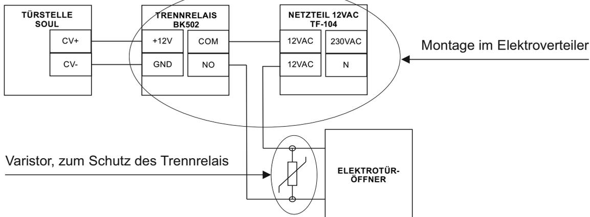
Anmerkung: Bei Ansteuerung eines Motorschlösses benötigen Sie das Netzteil TF-104 und den Varistor nicht. Schalten Sie mit COM / NO den Steuerkontakt des Motorschlösses.
