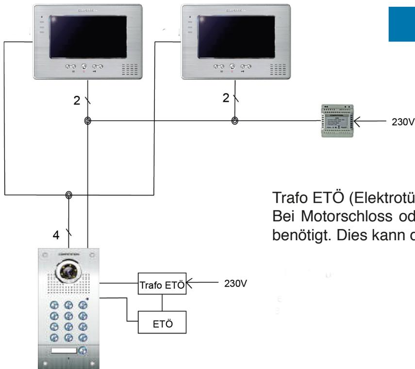
Trafo ETÖ (Elektrotüröffner) nicht im Lieferumfang. Bei Motorschloss oder A-Öffner wird nichts weiter benötigt. Dies kann direkt angesteuert werden.
