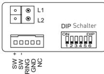
**L1, L2:** 2-Draht-BUS Anschluss
