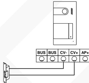
Wollen Sie den Türöffner mit Wechselstrom schalten, so verwenden Sie ein 12VDC Trennrelais (zBsp ArtNr 05-06-01) und ein Wechselstromnetzteil. Das Beispiel zeigt ein Golmar SAR-12/24 Relais und Netzteil TF-104 (12VAC/1.5A). Auch dem Produkt liegt ein kleines Trennrelais bei.
