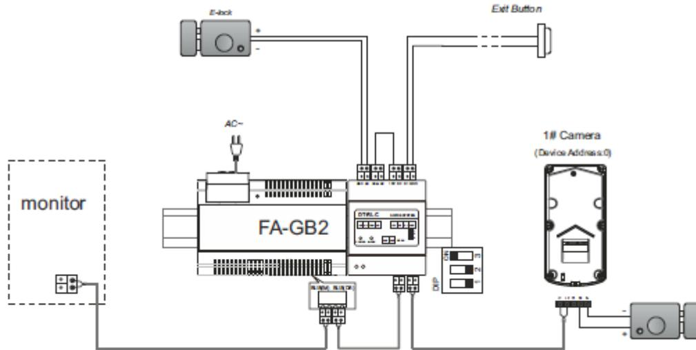
**19. Anschlussplan des SAR-GB2 Moduls für die Zuschaltung von Lichtquellen über die Monitore**
