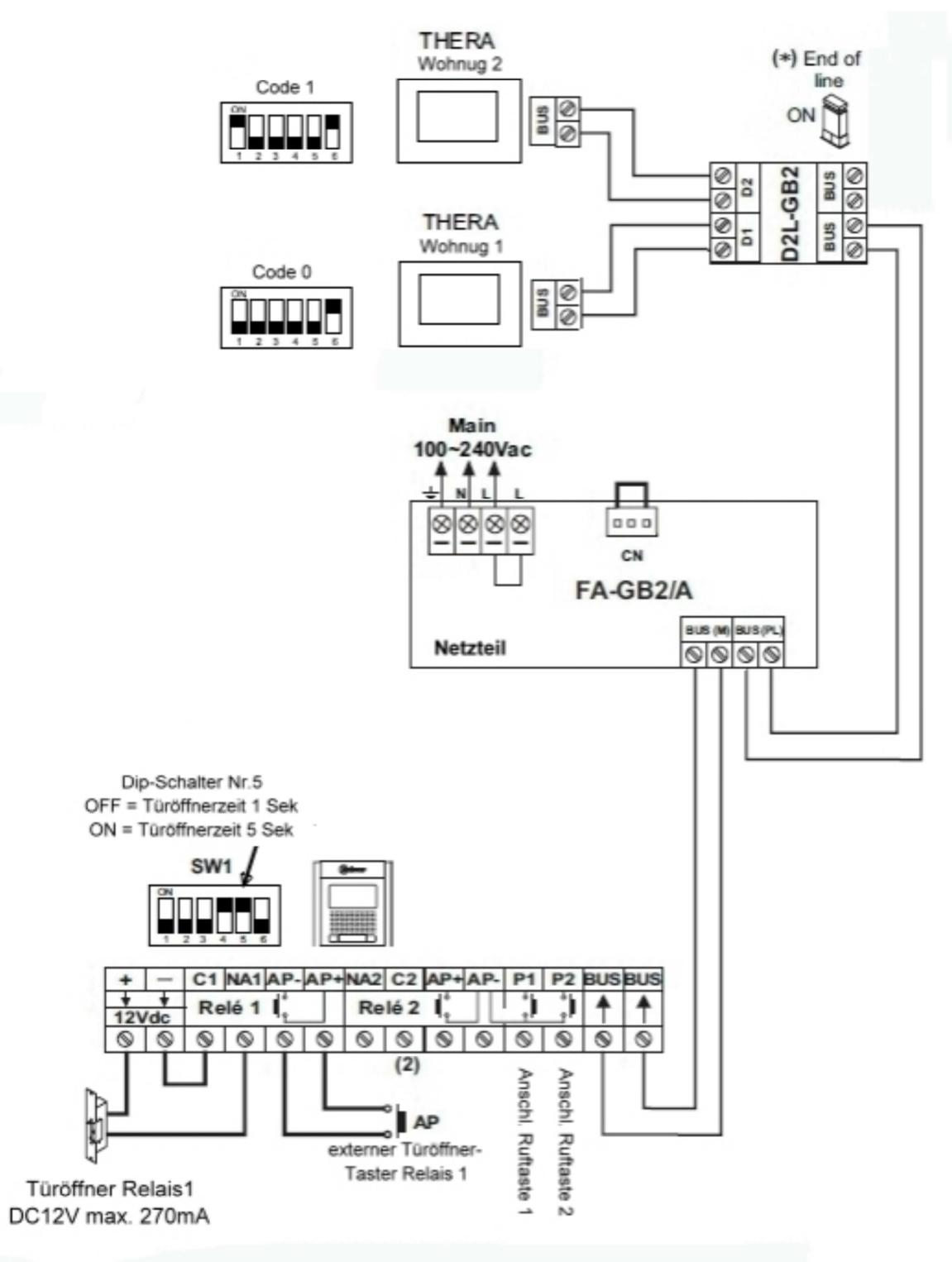
13. Anschlussplan GB2 Monitore bei Nutzung des Ruftastenmoduls EL610D
