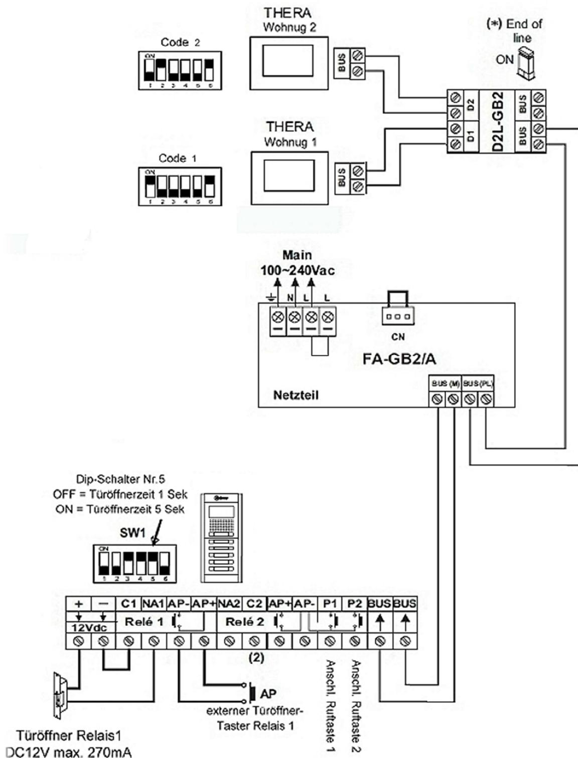
14. Anschlussplan mit GB2 Zusatzmonitoren und Zusatzkameras und Ruftasten P1 & P2
