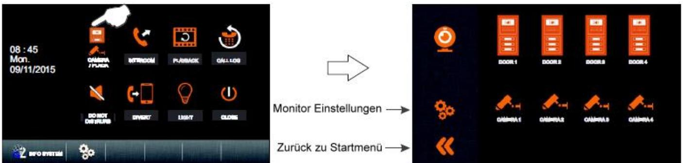
Mittels Druck auf das Kamerasymbol Kamera 1 wird die Kamera die an Anschluss 1 angeschlossen wurde angezeigt. Mittels Druck auf das Kamerasymbol Kamera 2 wird die Kamera die an Anschluss 2 angeschlossen wurde angezeigt. Mittels Druck auf das Kamerasymbol Kamera 3 wird die Kamera die an Anschluss 3 angeschlossen wurde angezeigt. Mittels Druck auf das Kamerasymbol Kamera 4 wird die Kamera die an Anschluss 4 angeschlossen wurde angezeigt.
