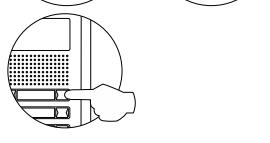
Realizar una llamada para comprobar que el monitor se ha programado con éxito. Programar el resto de monitores de la misma forma. Finalizada la programación coloque el interruptor de programación en OFF.
