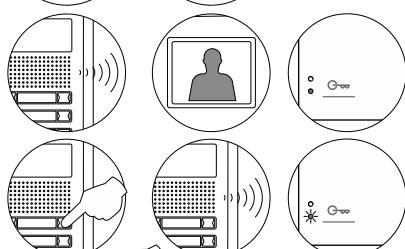
Para programar el monitor como **Principal**, pulse el botón **A<sub>0</sub>** durante 3 segundos, (el led de estado del monitor se ilumina fijo en color rojo).
