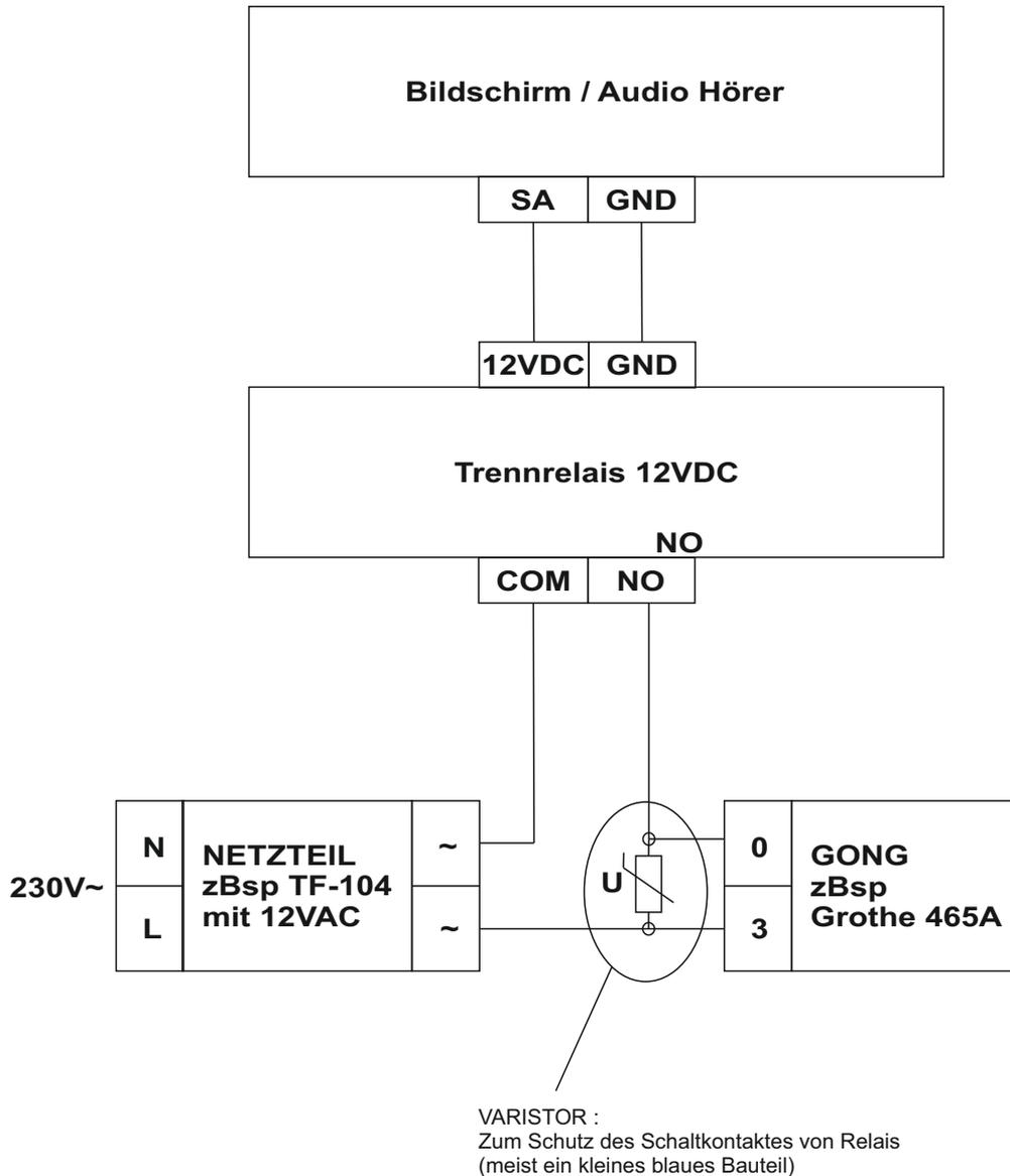
Das Netzteil für den Gong kann auch für die Versorgung von Elektrotüröffner oder einem Motorschloss verwendet werden.
